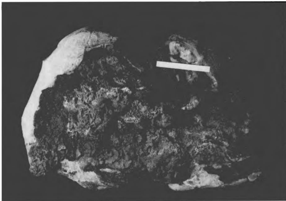
Abb. 2: Eisenkruste auf Malmkalk in typischer Ausbildung. Dicke, z. T. wulstige Eisenlagen greifen in Spalten und Vertiefungen ein. Maßstab: 5 cm. (Foto: E. Keck).
